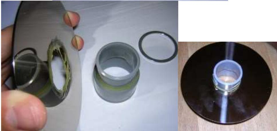
d) Il convient de percer les deux disques, avec un foret de 3mm de diamètre environ. Une fois que ce trou sera percé, il conviendra de fixer la cosse à œil, que l'on immobilisera avec un boulon (vis + écrou).
