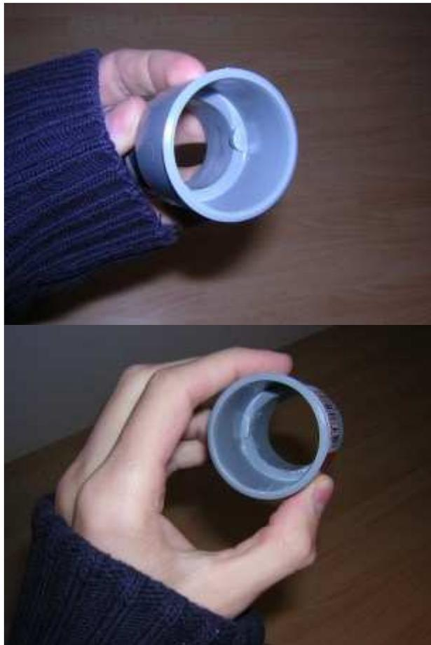
c) Le disque métallique doit être fermement immobilisé au réducteur PVC. Pour cela, on aura recours à de la colle assez puissante (que l'on peut se procurer dans une quincaillerie, ou dans un magasin de bricolage). Il faudra laisser sécher l'ensemble, durant 24heures environ. Je vous recommande de respecter ce délai, car hâter les choses ne serait pas un gage de réussite.
