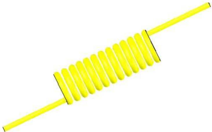
Quelques mètres de câbles coaxial, du type RG578, ou mieux, du 11mm.
